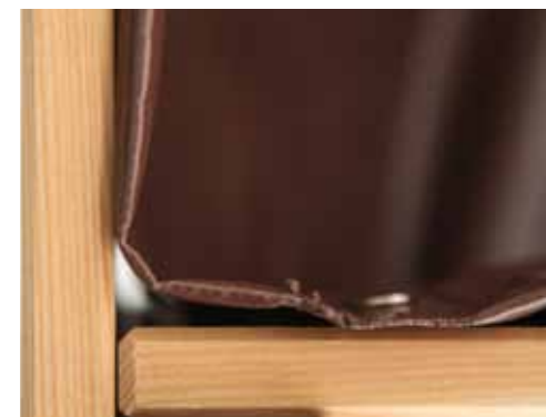
Sacca di contenimento in PVC all'interno della cover esterna in legno
